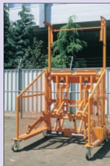
TS-CM Hefvermogen 500 kg Max. hefhoogte 1450 mm Containers 25-1100 ltr
