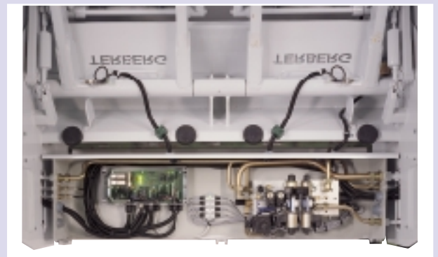
De zich onder de belading bevindende gemakkelijk bereikbare service box herbergt de hydraulische en elektrische componenten
